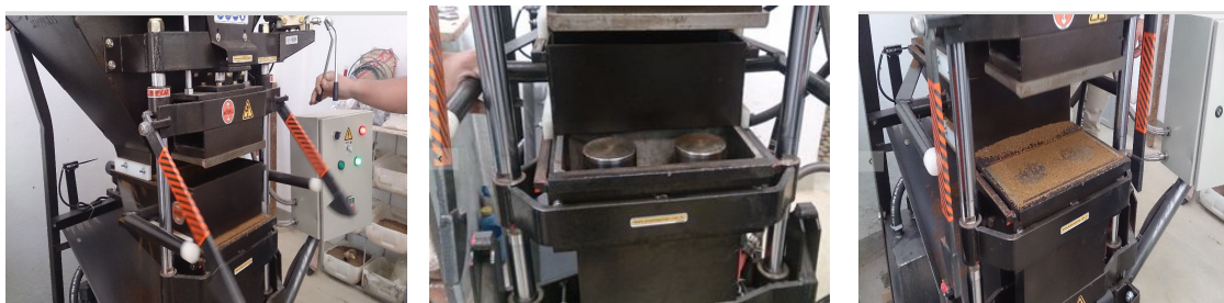
Figura 2. Sequência do funcionamento da caixa carregadora.
