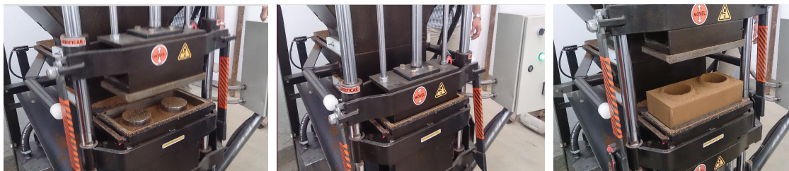
Figura 3. Sequência do procedimento de moldagem do tijolo ecológico.
