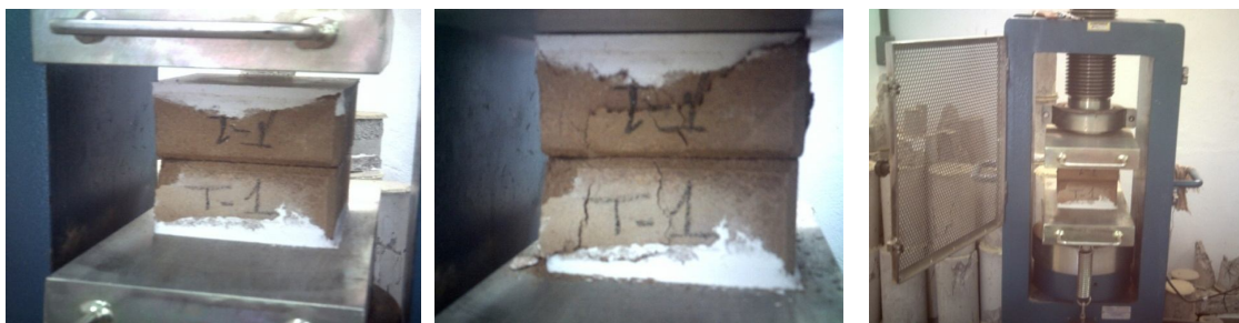
Figura 5. Sequência do ensaio de compressão dos corpos de prova, até a ruptura.
