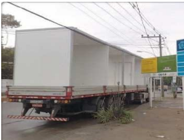
Figura 2 - Transporte dos módulos montados
