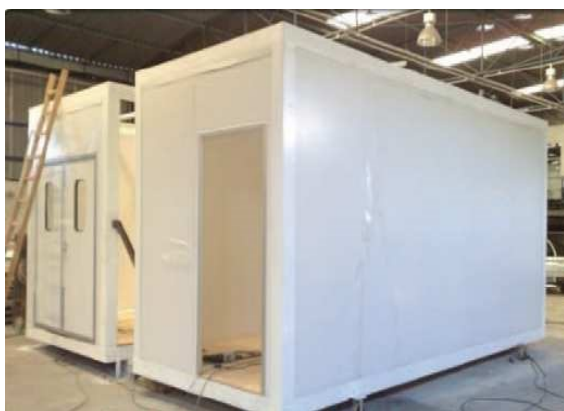
Figura 1 – Módulos montados em fábrica.
